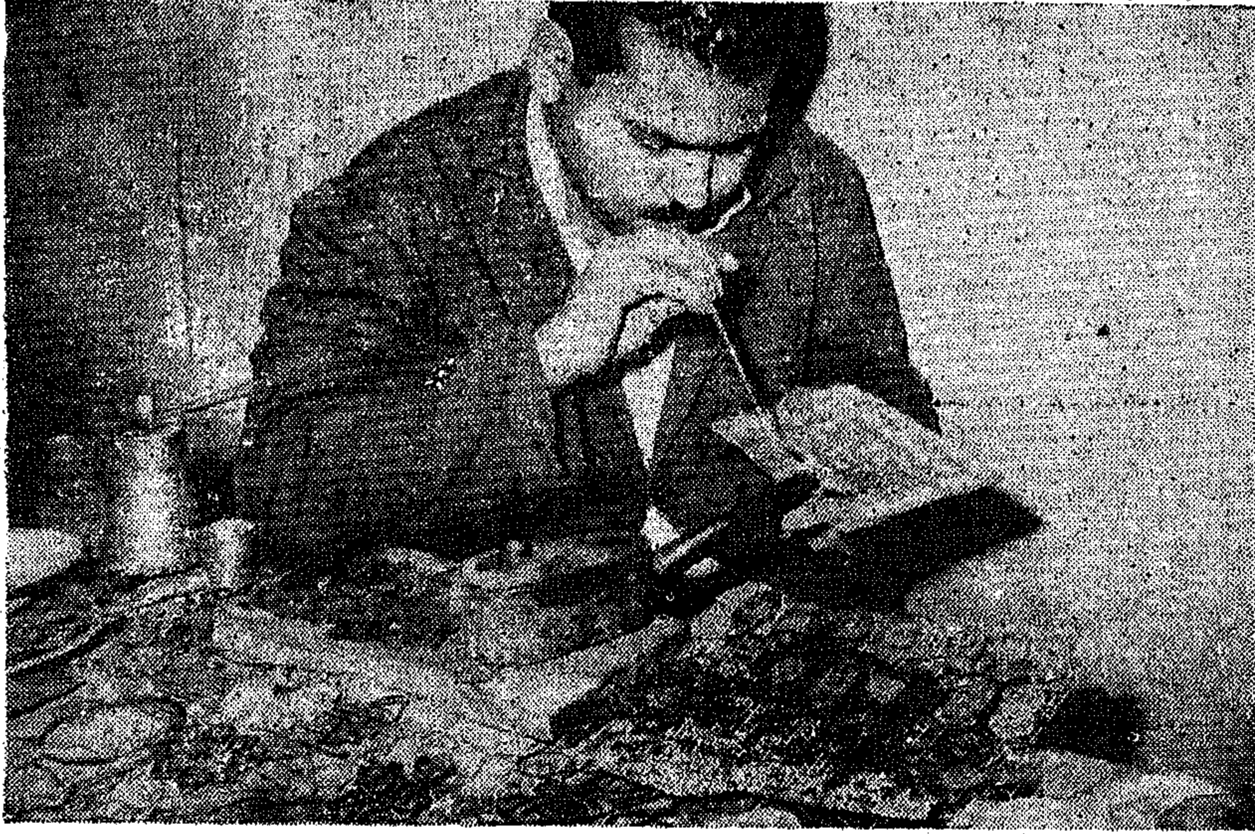
لوحة رقم ٧١ - صانع يقوم بلحام قطع من المصاغ الشعبي بعد ملئها ورضها بأسلاك الشفتشى ، (الصاغة) .
